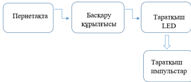
3.8-сурет – Таратқыш бөлімінің жұмыс жасау схемасы
